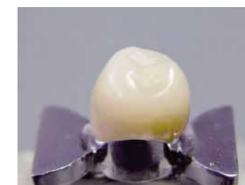
Отсутствие трещин после проведения 5000 циклов тепловых испытаний холодной и горячей водой
