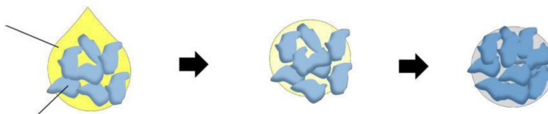
Рисунок 4 Схематическое изображение процесса производства наполнителя SphereTEC®. Слева направо: 1. Распыление смеси, содержащей тонко диспергированное бариевое стекло, активированный полимер и растворитель; 2. Формирование сфер и испарение растворителя; 3. Полимеризация для получения предварительно полимеризованных, сферических гранул
