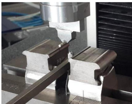
Рисунок 28 Схема трехточечного испытания с экстенсометром (Lohbauer U.)
