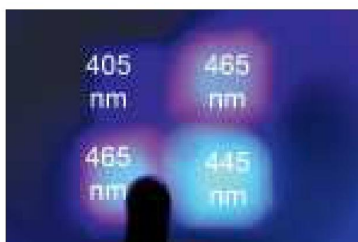
Четыре светодиода VALO охватывают диапазон 395-480 нм. Обратите внимание на световые пятна разных цветов; цифрами обозначен пик каждого светодиода.
