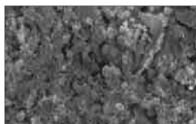
Остаточные силикаты на керамике, после протравливания плавиковой кислотой в течение 90 секунд с использованием Porcelain Etch.
