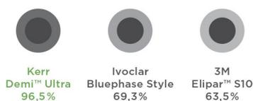
Равномерность измерена на основании среднего распределения освещенности по периметру и выражена в процентах к освещенности в центральной части светового луча диаметром 4 мм.
