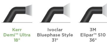
Сравнение основано на измерении угла отклонения светового пучка
