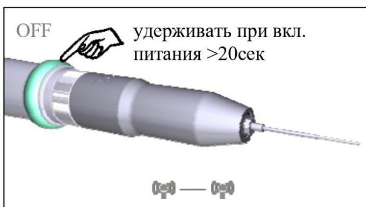
Нажмите и удерживайте кнопку при включении питания. После завершения 3-х циклов звуковых сигналов с разной интенсивностью звука и
