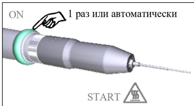
автоматически, если температура в гильзе нагревателя превышает 100°C
