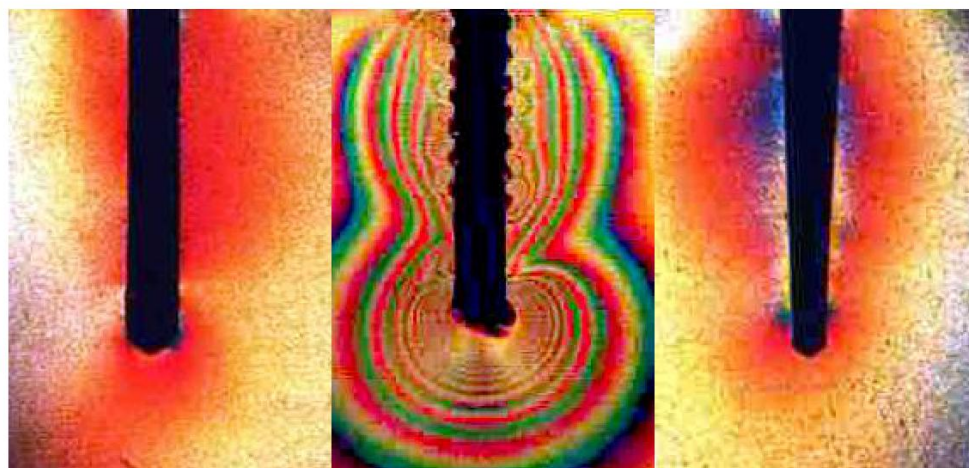
Нагрузка, оказываемая на корень зуба различными по форме хвостовиками штифтов
