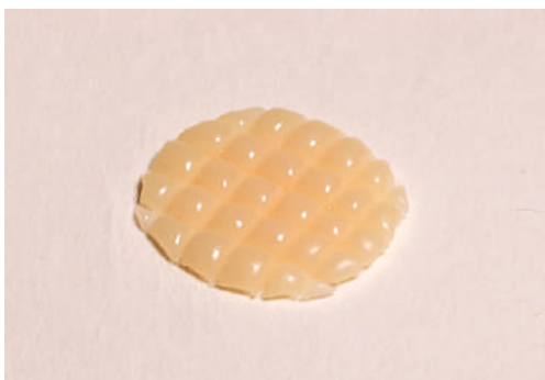
Микрорельеф поверхности неотвержденного композита Реставрин после выдержки при 37 °С в течение 20 мин.
