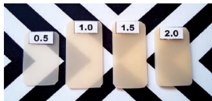
Прозрачность образцов различной толщины (0,5 - 2,0 мм) универсального оттенка А2
