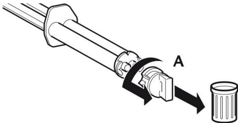
1. Перед установкой смесительного наконечника снимите колпачок [A] или использованный смесительный наконечник, повернув его против часовой стрелки на  $90^\circ$ , и выбросьте.
