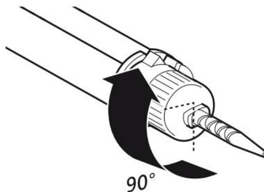
3. Зафиксируйте смесительный наконечник, повернув его по часовой стрелке на  $90^\circ$ .
