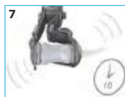
7 Вставьте капсулу в капсуломеситель, замешайте в течение 10 сек.
