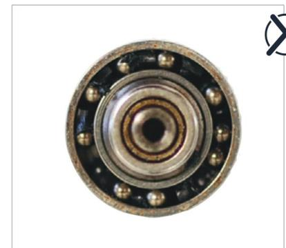
**Только регулярная смазка позволит избежать преждевременного износа подшипников, узлов и механизмов стоматологического наконечника**
