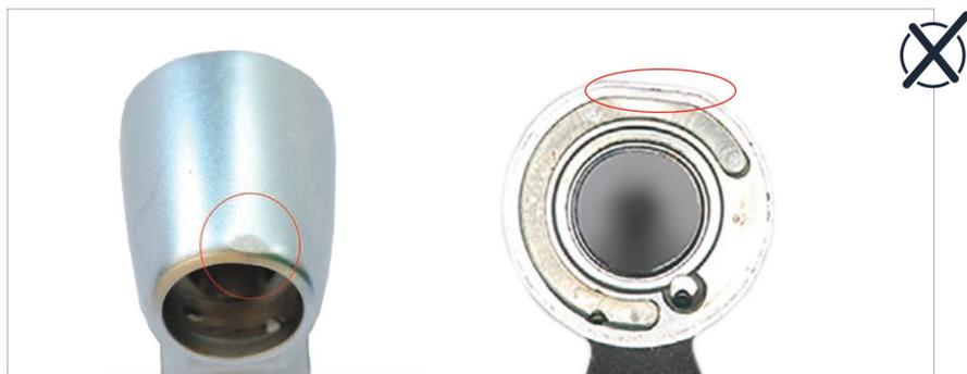
*Сопутствующие падению повреждения (например, деформация корпуса наконечника) могут привести к перегреву подшипников и, как следствие, быстрой поломке наконечника*
